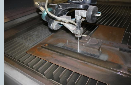
Usinage d'une éprouvette par jet d'eau abrasif
